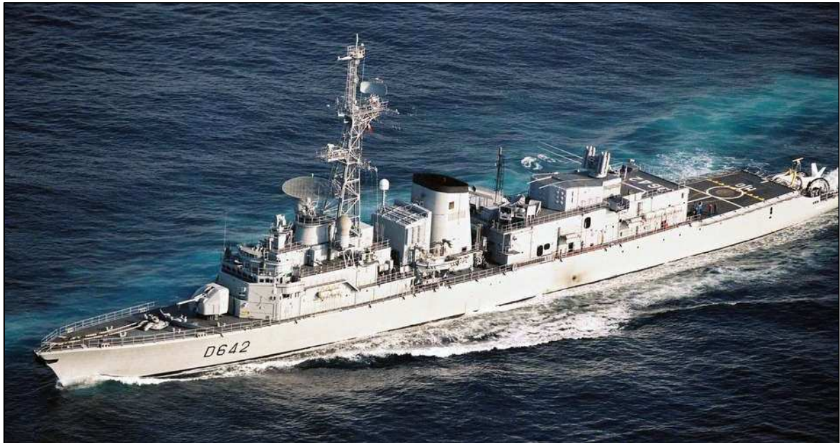
La corvette C70 Montcalm dans sa configuration d'origine : les MM 40 ont remplacé les MM 38 des deux précédentes derrière la cheminée.
