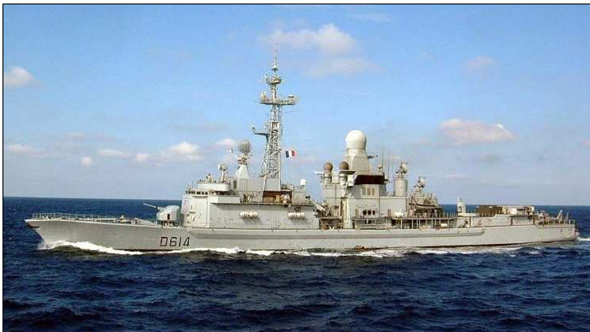
La frégate F70 AA Cassard, seconde de sa classe – les bulges destinés à renforcer la structure longitudinale au niveau du pont principal sont déjà visibles.
