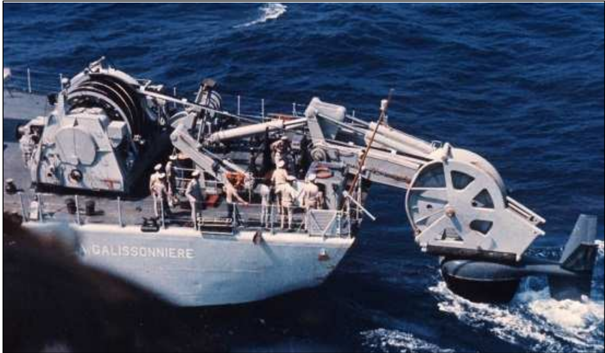
Système de mise à l'eau du sonar remorqué, les formes arrières ont été adaptées et seront reprises pour les escorteurs d'escadre T47 refondus ASM.
