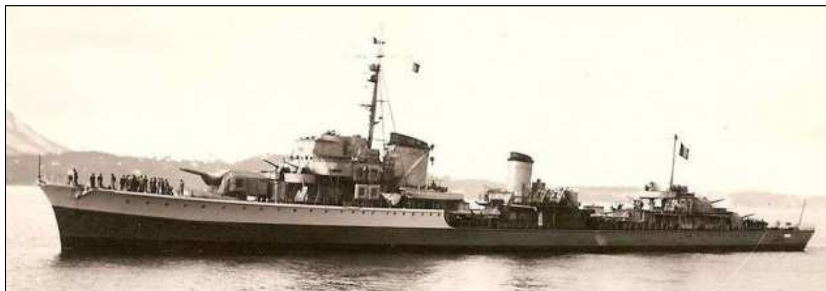
Le contre-torpilleur Hoche, ex-Z25, sous couleurs françaises (remarquer la tourelle double de 150mm à l'avant).
