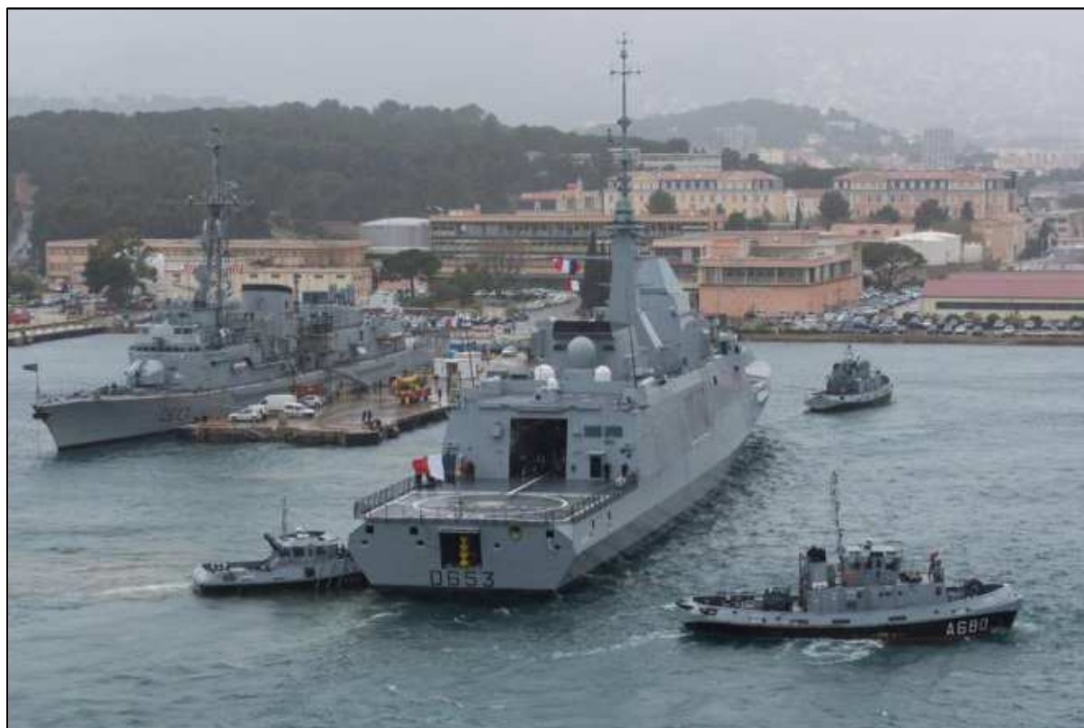
La frégate Languedoc accostant à Toulon : le gabarit est visiblement plus important que celui de la frégate F70 déjà à quai, le sonar remorqué est visible avec sa porte de tableau ouverte.
