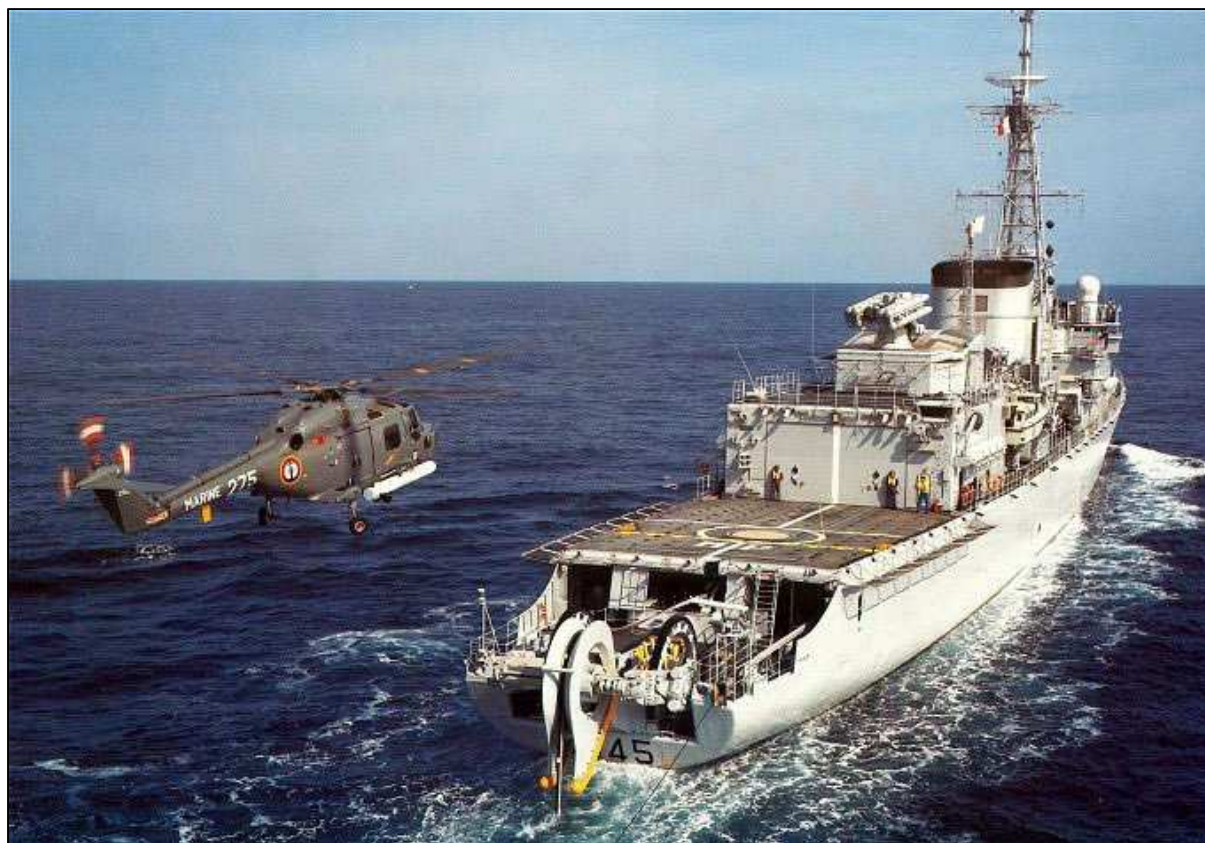
La frégate Lamotte-Picquet avec son sonar remorqué à l'eau, un Lynx apponte avec une torpille d'exercice.
