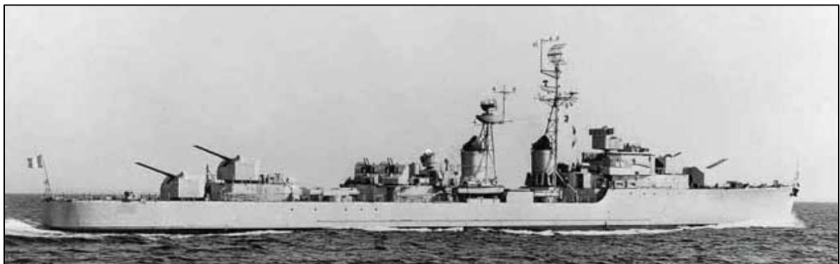
Le Surcouf : l'ensemble de l'armement est particulièrement visible, avec notamment les deux modèles de tubes lance-torpilles, longs à l'arrière et courts au milieu.
