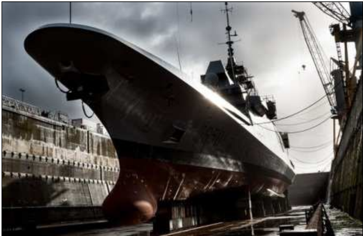
La frégate Aquitaine au bassin. On remarque l'absence d'aileron de stabilisation.
