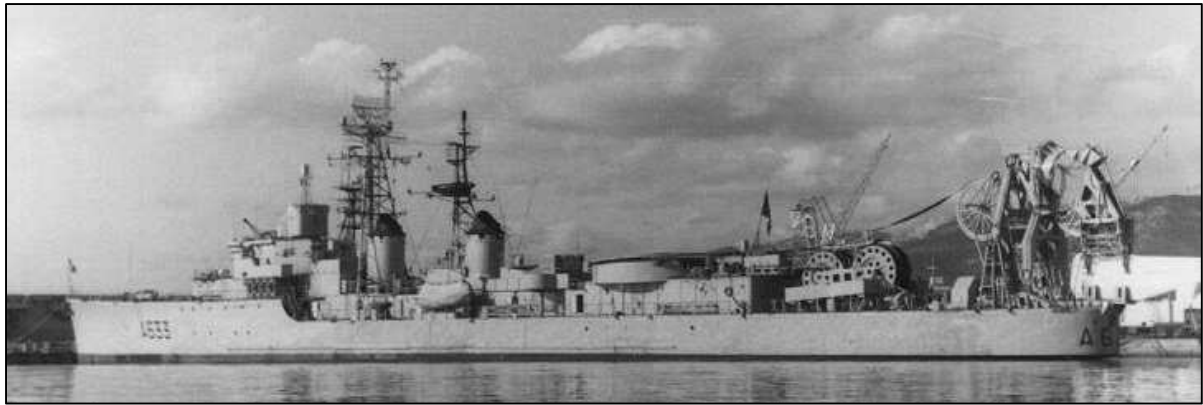
L'escorteur d'escadre Duperré en bâtiment d'expérimentation ASM (sans armement et sous numéro de coque d'auxiliaire A 633) avec à l'arrière un imposant dispositif de mise à l'eau d'un sonar remorqué profond.
