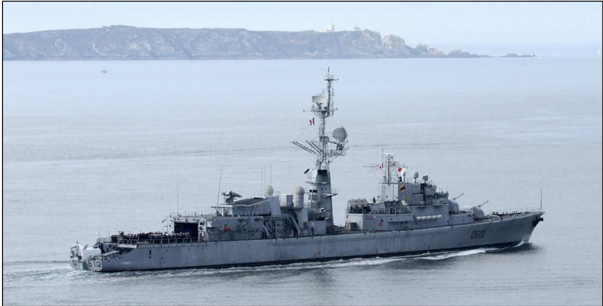
La frégate De Grasse devant le Toulinguet lors de sa dernière sortie, le 6 mai 2013. Les superstructures arrière se sont alourdies et au milieu, le Malafon a disparu.
