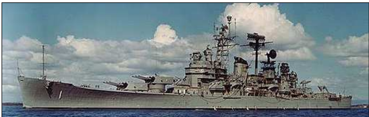
Le croiseur lourd USS Boston, avec deux systèmes Terrier à l'arrière et encore ses tourelles triples de 203 mm à l'avant.
