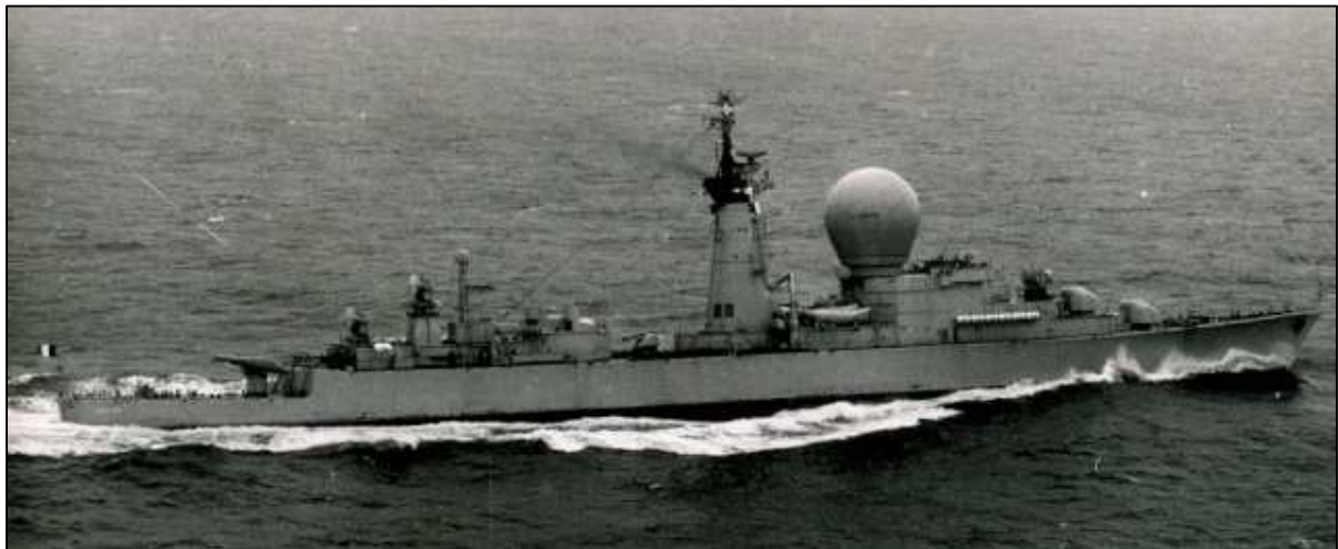
La frégate Duquesne lors de ses essais en 1969 (le sonar remorqué n'est pas encore embarqué).
