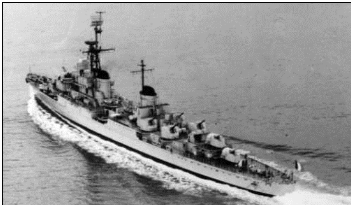
Le croiseur léger Guichen refondu en prototype d'escorteur d'escadre.
