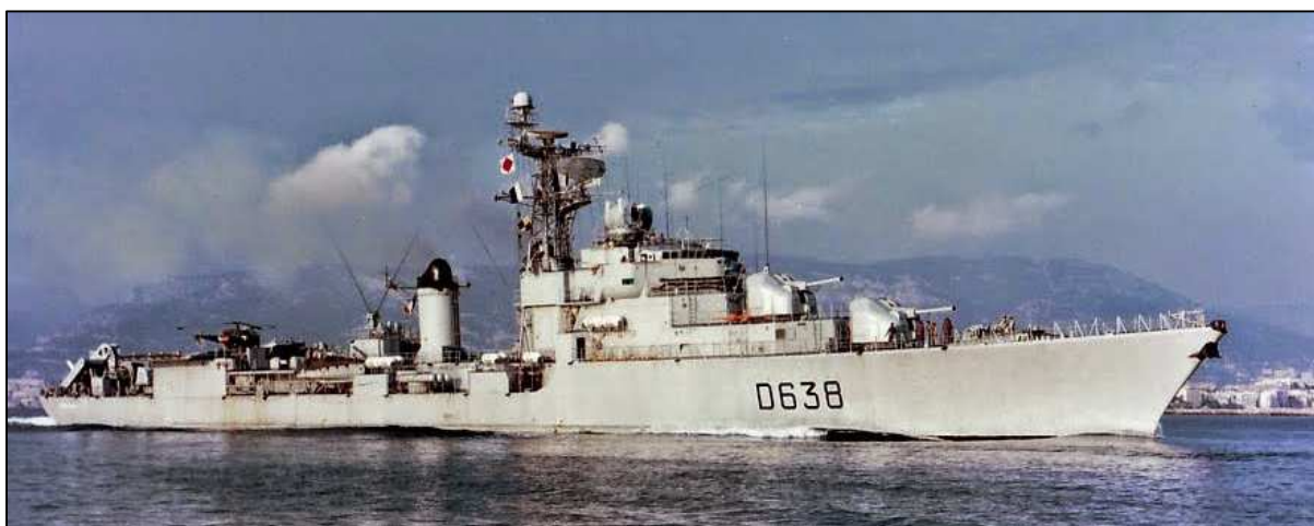
L'escorteur d'escadre La Galissonnière, le 7 novembre 1975, avec le hangar déployé en plateforme d'appontage.
