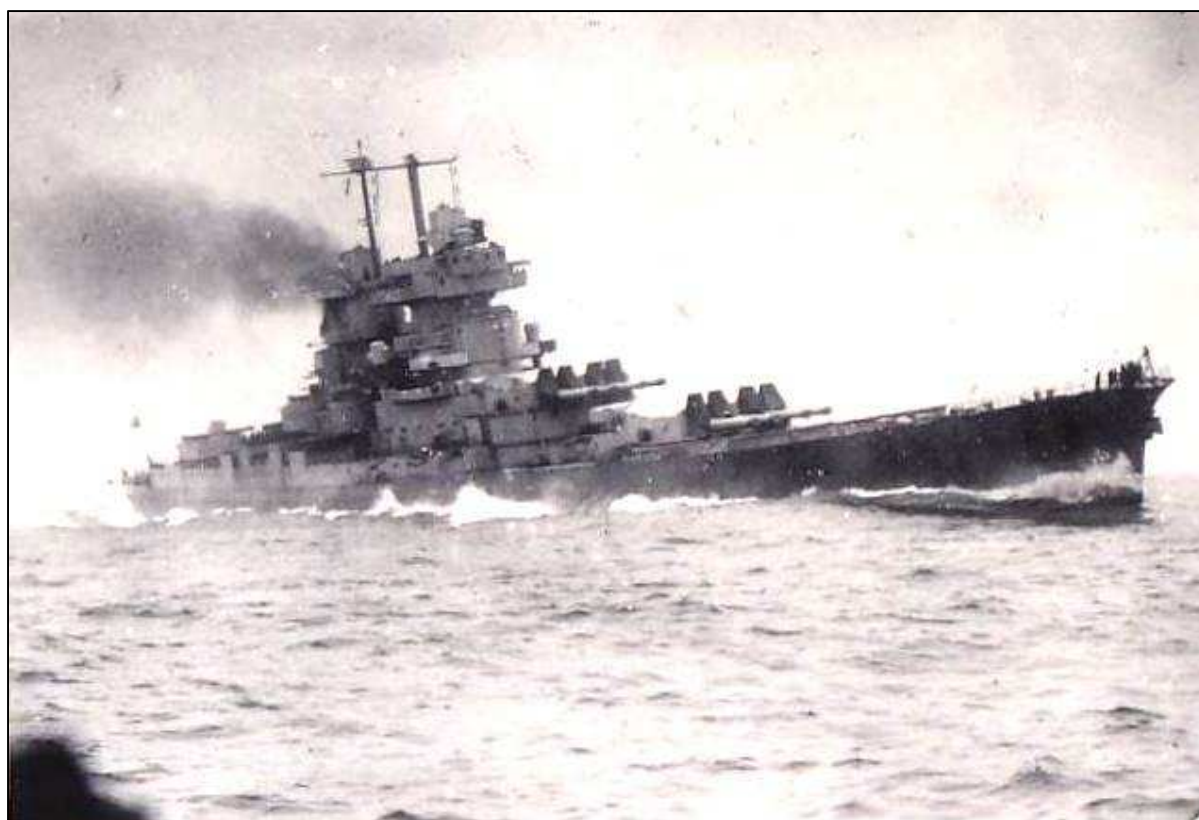
Le bâtiment de ligne Jean Bart lors de ses essais de vitesse en 1949. Seuls les télépointeurs d'artillerie principale sont en place, tout l'armement antiaérien de 100 mm et de 57 mm ainsi que les télépointeurs correspondants et l'équipement radar ne sont pas encore prêts.
