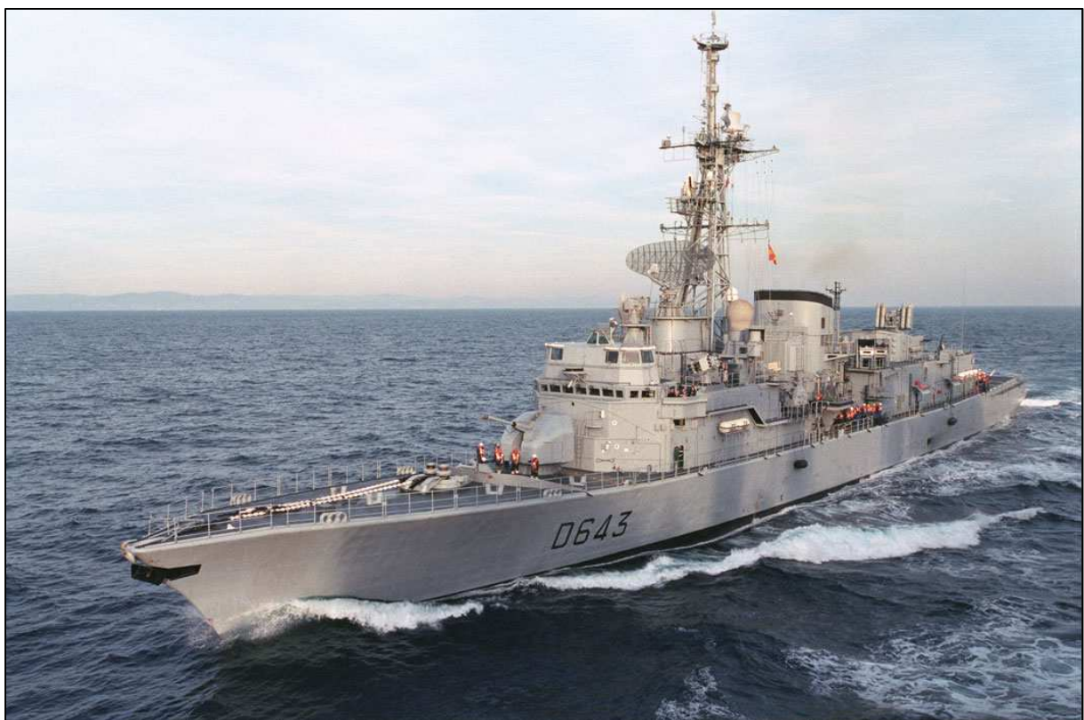
La frégate Jean de Vienne en 2001 : les éléments de la refonte OP3A sont visibles, notamment la nouvelle passerelle de défense à vue et affûts de 30 mm en abord de la passerelle.
