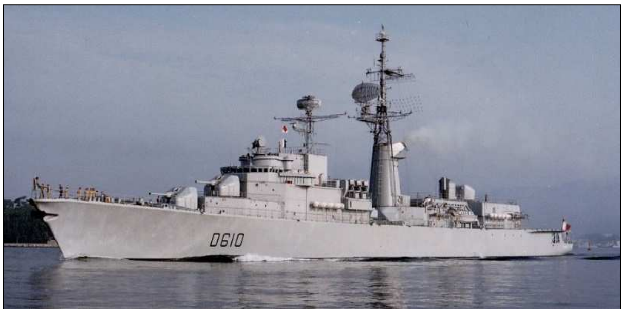
La frégate Tourville dans son état d'origine en juillet 1976, avec une troisième tourelle de 100 mm devant le hangar hélicoptère.
