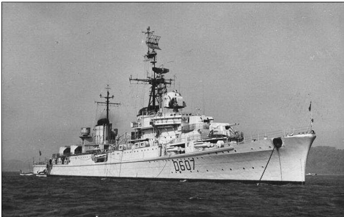
L'escorteur d'escadre Guichen dans son dernier état. Nouveaux télépointeurs et affûts de 57 mm, mais tourelles de 105 mm de récupération.
