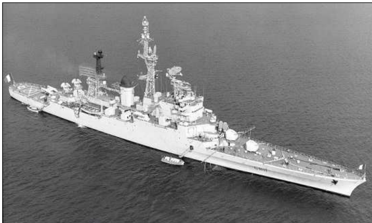
Le croiseur Colbert refondu au mouillage, les rampes MM38 installée derrière la seconde tourelle de 100 mm.
