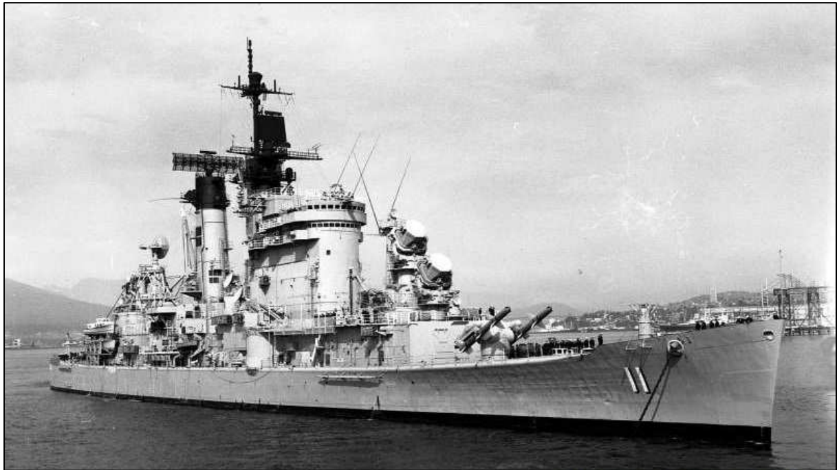
Le croiseur USS Albany, totalement refondu, avec son système Talos visible à l'avant ainsi que les rampes doubles Tartar sur le travers du bloc passerelle.
