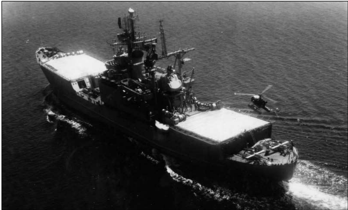
Le bâtiment d'expérimentation Ile d'Oléron, avec la rampe simple d'essai Masurca à l'avant sur le pont principal et des cibles CT10 à l'arrière. Appontage d'une Alouette II à flotteurs.
